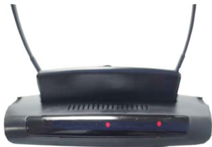
figure 3 2 LED indiquent que l'unité est en charge.
